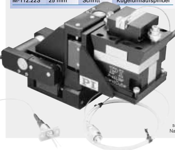
M-110 XYZ Hybrid-System mit NanoCube™ für extrem schnelles Positionieren im Nanometerbereich.
